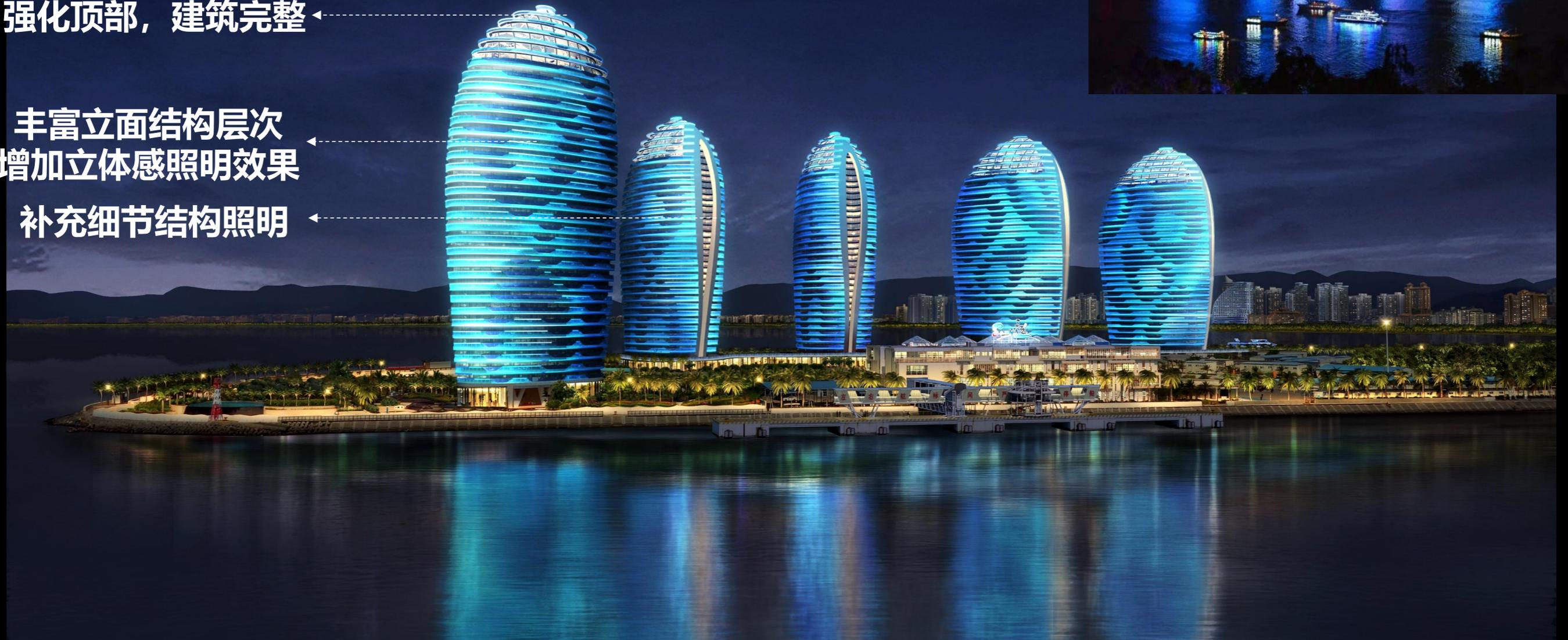
点光源实现媒体面需求，洗墙灯洗亮镀点玻璃实现建筑幕墙图案并与媒体面同步变化，增加画面质感，提升品质
